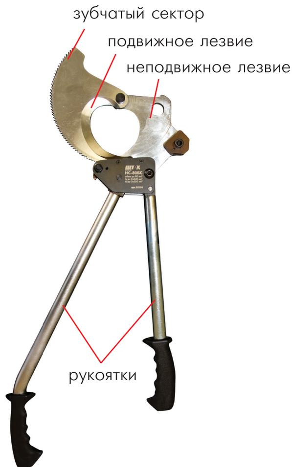
Основные детали секторных ножниц HC-80BC представлены на рисунке. Перерезание кабеля с помощью этих ножниц осуществляется в ходе поворота подвижного лезвия вокруг соединительного шарнира. Благодаря оригинальной геометрии лезвий в каждый момент реза достигается равномерное всестороннее воздействие режущего контура на разрезаемый участок. Это обеспечивает точность реза, минимальную деформацию и отсутствие "вытягивания" жил кабеля.
