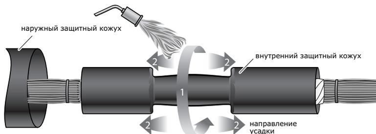
**10.1** Надвинуть внутренний защитный кожух на место соединения жил, разместить его по центру муфты и усадить, начиная с середины.
