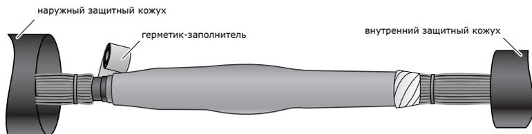
**9.1** Используя герметик-заполнитель из комплекта муфты произвести намотку на края толстостенных манжет с заходом на полупроводящий слой. При намотке герметик вытягивать примерно в 1,5–2 раза.
