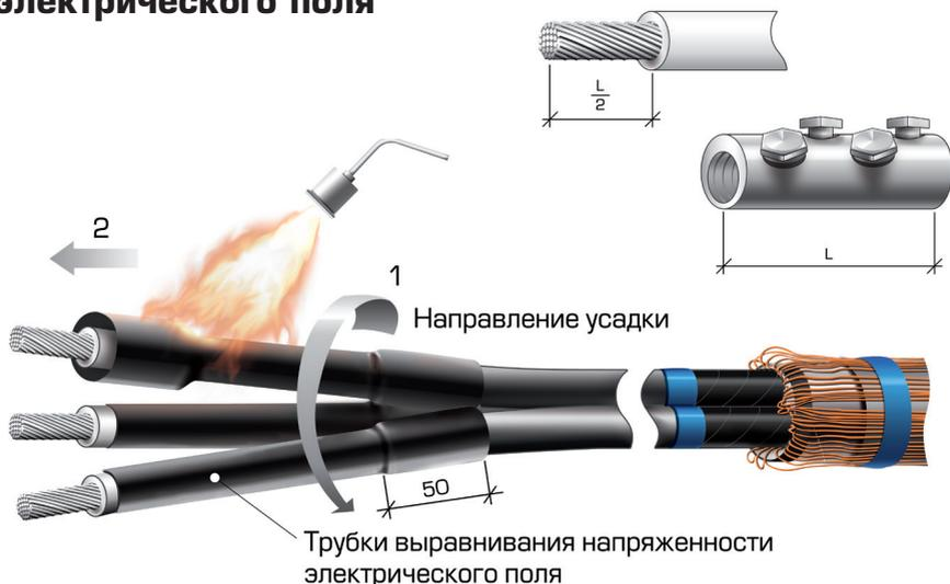
**5.1** Снять с концов всех жил изоляцию на длине, равной  $1/2$  длины гильзы (соединителя). Если используется соединитель с внутренней перегородкой, изоляция удаляется на участке, равном длине соединителя до перегородки.
