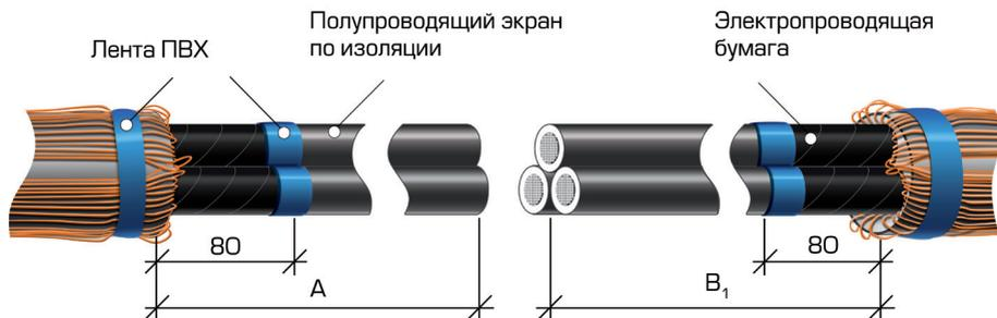
**2.2** Расплести медные бандажные ленты и медные проволоки экрана каждой жилы обоих концов кабеля; без натяга отогнуть их на наружную оболочку кабеля и с помощью изоляционной ленты ПВХ временно закрепить на наружной оболочке кабеля.
