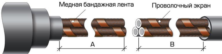
**2.1** Удалить с кабеля оболочку и межфазный наполнитель согласно рисунку и таблице (разделка на размер А должна проводиться со стороны кабеля с надетыми кожухами).
