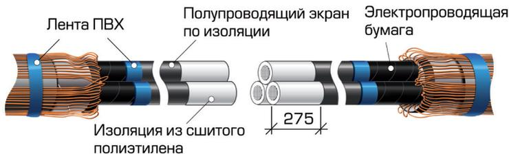
**4.1** Специальным инструментом (роликовым ножом) удалить слой черного полупроводящего экрана по изоляции из экструдированного сшитого полиэтилена с каждой жилы обоих концов кабеля на длину 275 мм от среза кабеля.
