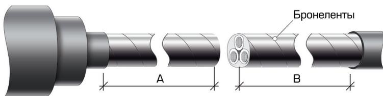
**3.1** Удалить с кабеля наружную оболочку согласно рисунку и таблице (разделка на размер А должна проводиться со стороны кабеля с надетыми кожухами).
