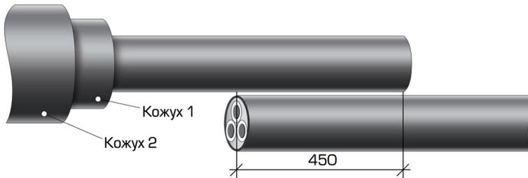
**1.1** Распрямить один конец кабеля на длине 2000 мм, другой — 1500 мм, очистить их от загрязнений и расположить их друг напротив друга с перехлестом в 450 мм.
