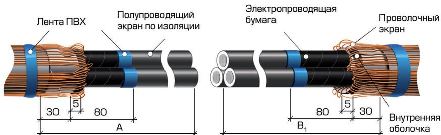
**3.2** На расстоянии 30 мм от среза наружной оболочки обоих концов кабеля специальным инструментом сделать кольцевые надрезы на бронелентах и снять броню. На расстоянии 5 мм от среза бронелент, сделать кольцевой надрез на внутренней оболочке кабеля и удалить внутреннюю оболочку и межфазный наполнитель.
