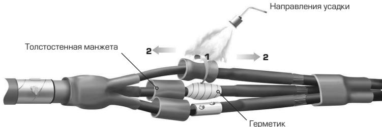
**11.1** Надеть на жилы кабеля с бумажной маслопропитанной изоляцией толстостенные изолирующие манжеты и свинуть их на время монтажа соединителей в сторону **малой** перчатки до упора.
