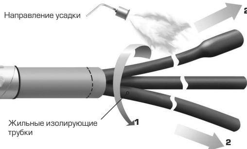
**3.1** Надеть на жилы кабеля с бумажной маслопропитанной изоляцией жильные изолирующие трубы и сдвинуть их до упора в основание разделки.
