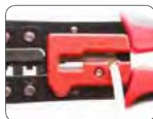
Зачистка круглого провода
