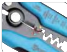
Опрессовка изолированного наконечника
