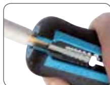
Снятие оболочки с круглого кабеля
