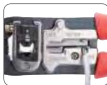
Зачистка круглого провода
