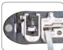
Зачистка плоского провода
