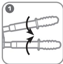
**Расфиксируйте рукоятки, повернув их вокруг оси.**
