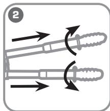
**Установите необходимую длину и зафиксируйте рукоятки, повернув их в противоположную сторону.**
