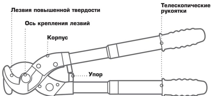
Ножницы состоят из лезвий повышенной твердости, оси крепления лезвий, корпусов и телескопических рукояток.
