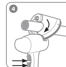
Перед установкой или снятием аккумулятора всегда отключайте инструмент. Для снятия аккумулятора, нажмите на фиксатор и выньте его из инструмента. Для установки аккумулятора вставьте его в корпус инструмента до щелчка, соблюдая полярность. Аккумулятор устанавливается только в одном положении.
