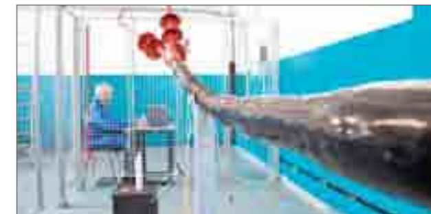
Высоковольтные испытания муфт
